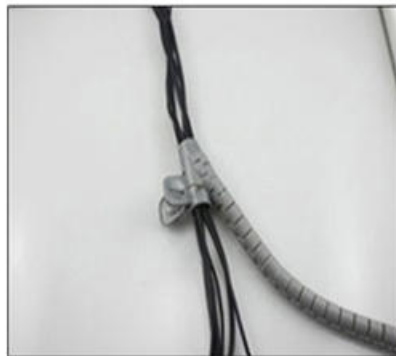
4.包線管通過引線器包住電纜
